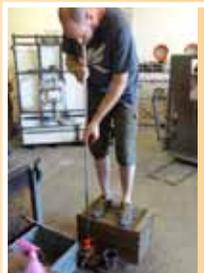
verrier. Nouveaux modelages... et l'objet terminé, séparé de sa canne par un choc thermique sera placé dans un four à refroidissement (520°) ; la température s'y abaisse au fur et à mesure afin d'éviter que le verre ne se casse.
