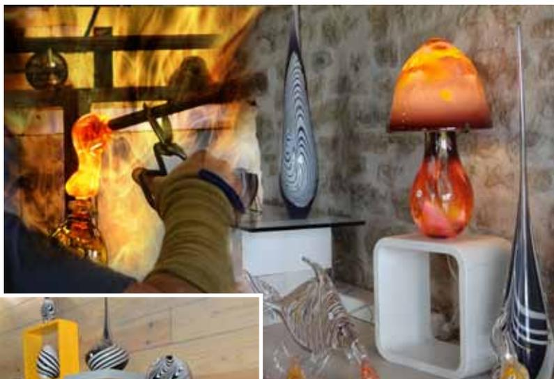
modelée. Pour maintenir sa pièce à bonne température l'artisan utilise un four ouvert. Celui-ci vient compléter les 2 autres fours : un pour maintenir le verre en fusion et un autre pour faire descendre le verre en température.
